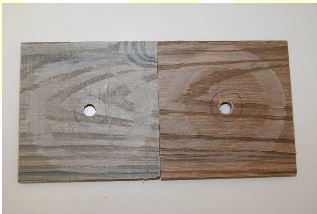
Fig. 2: Imagen del resultado del ensayo de abrasión a los 1000 ciclos de la muestra
