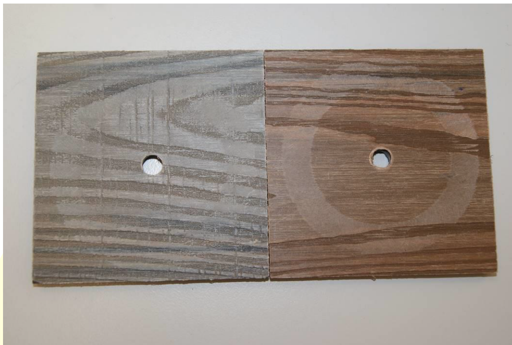
Fig. 1: Imagen del resultado del ensayo de abrasión a los 500 ciclos de la muestra
