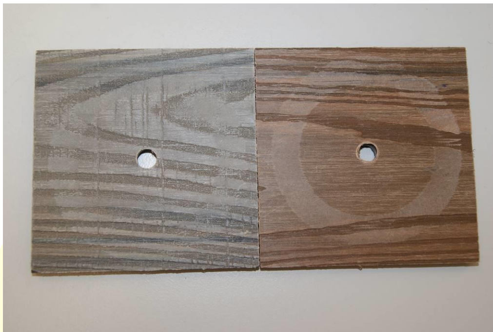
Fig. 1: Imagen del resultado del ensayo de abrasión a los 500 ciclos de la muestra ON-DECK ENCAPSULADO.
