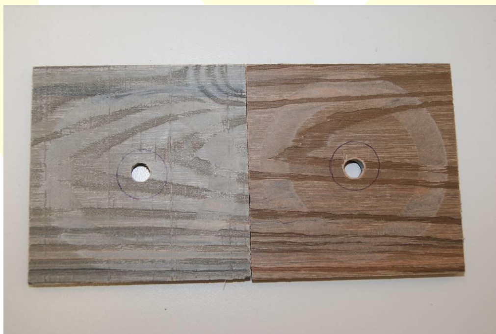
Fig. 2: Imagen del resultado del ensayo de abrasión a los 1000 ciclos de la muestra ON-DECK ENCAPSULADO.
